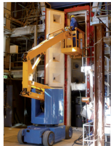
Bild 5: Arbeiten am offenen Stützenbrandofen an der BAM (Bundesanstalt für Materialforschung und -prüfung), Berlin (Foto: Alphabeton AG).
