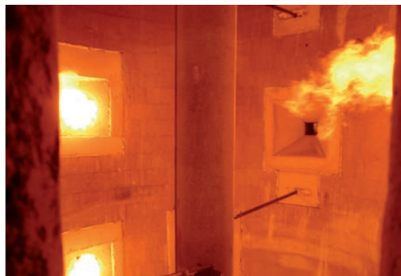
Bild 6: Brandversuch unter Last an der Bundesanstalt für Materialforschung und -prüfung (BAM), Berlin, Mai 2013. Blick in den Brandofen während der Befuerung (Foto: Alphabeton AG).
